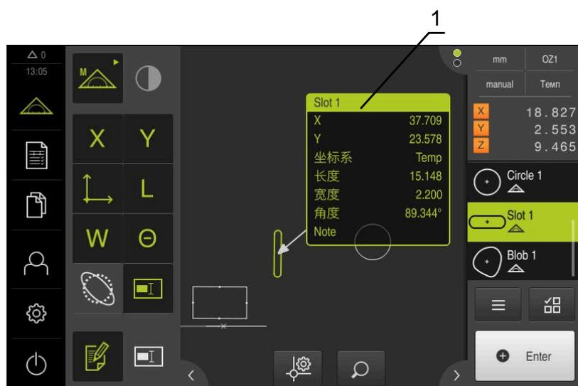
图 77: 带几何元素测量信息的几何元素视图
