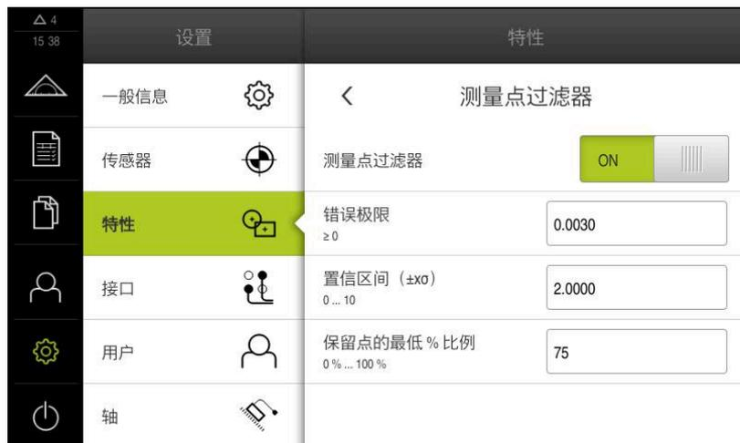
图 92: 测量点过滤器的设置
