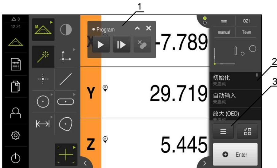
图 85: 测量程序的显示和控制
