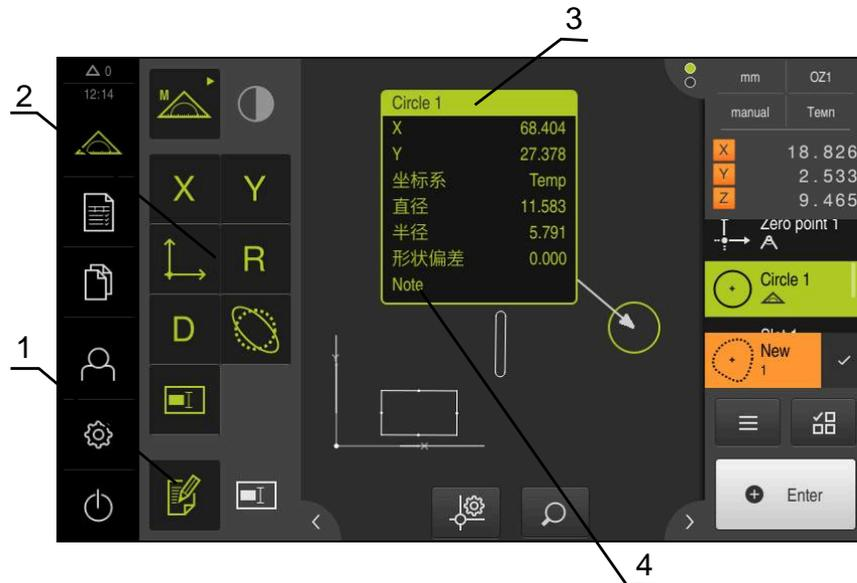
图 54: 注释的操作件和带注释的几何元素
