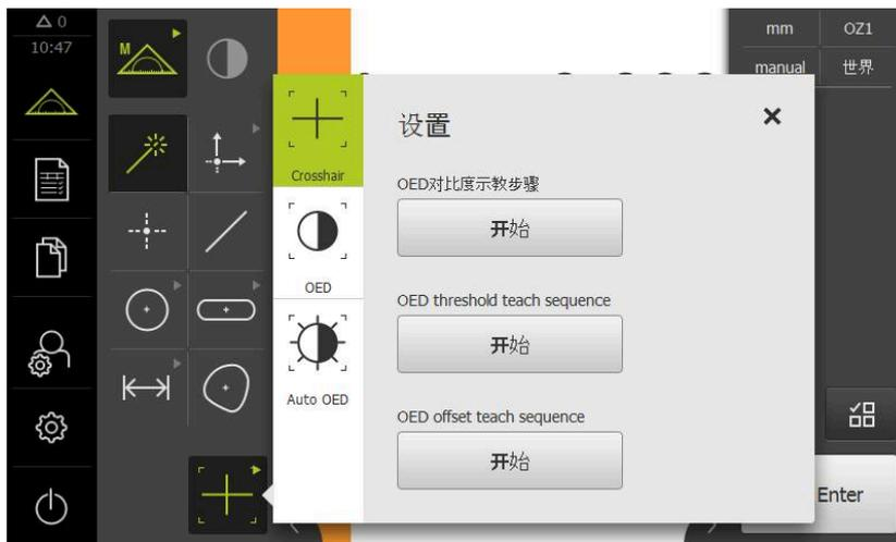
图 18: OED测量工具的**设置**对话框
